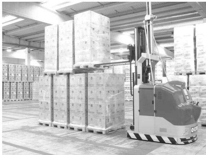
**Figura 1.4.6. Empilhadeira laser-guiada da OCME SRL.**
