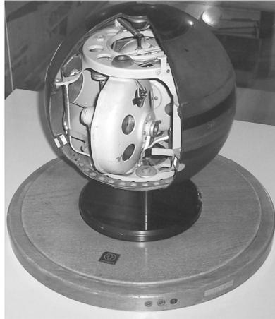
Figura 3.4.7. Giroscópio de orientação desenvolvido por Herman Anschütz-Kaempfe em 1903.
