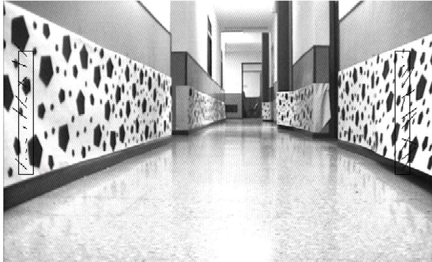
Figura 4.7.1. Imagem do corredor por onde navega o robô móvel e o campo de fluxo óptico resultante.
