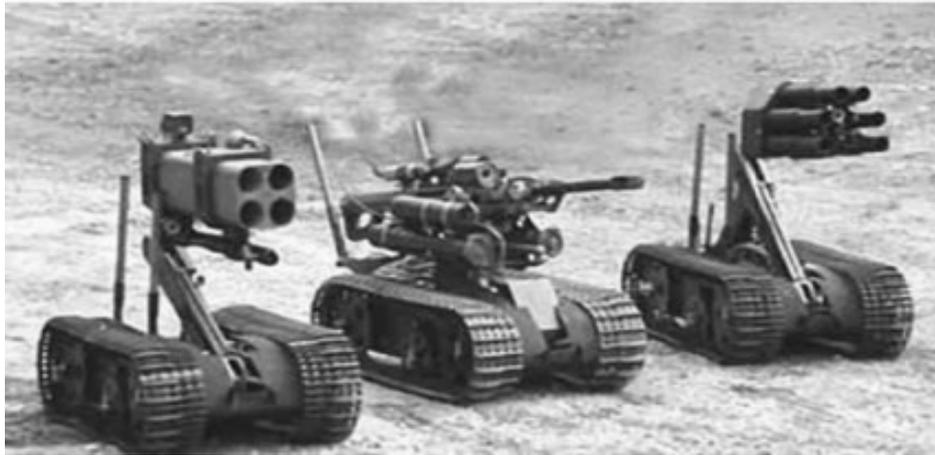
**Figura 1.4.11. Robô soldado TALON utilizado pelo exército dos EUA no Iraque.**
