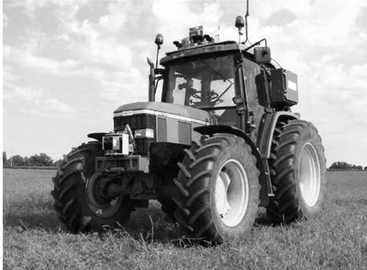
**Figura 1.4.8.** A NREC (National Robotics Engineering Center) converteu o trator 6410 da John Deere em um veículo autônomo capaz de percorrer 7 km sem necessidade de um operador.
