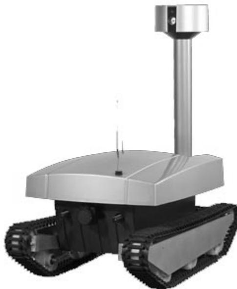
**Figura 1.4.12. Robô de vigilância urbana OFRO da empresa RobotWatch.**
