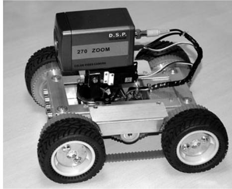
**Figura 1.4.1.** Inspector Bot da Eventronic ES, um robô que inspeciona tubulações.
